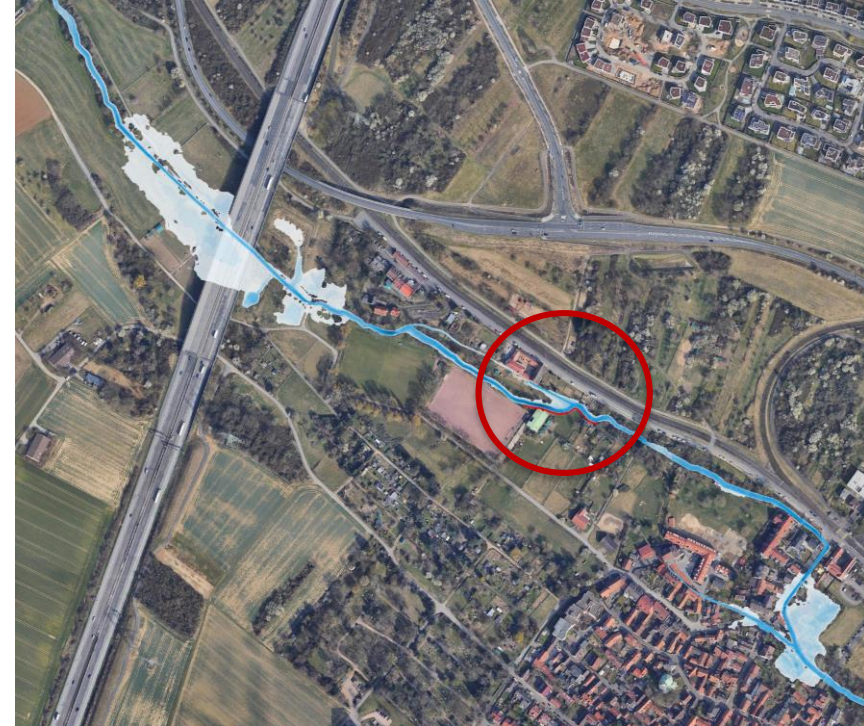
Überschwemmungsflächen, HQ 2, mit Verwallung
