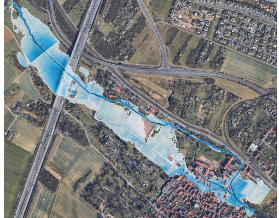
Überschwemmungsflächen, HQ 100, mit Rückhaltung
